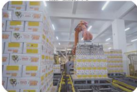
图摄：智能机器人码垛系统
